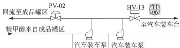
图 6 泵区现在安装平面图
