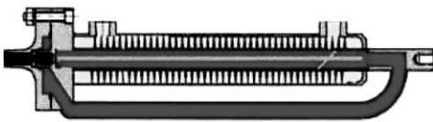
图 7 VPGH 加热结构示意图
