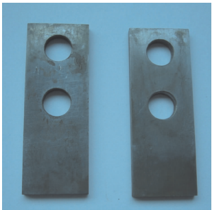
b) 试片腐蚀后形貌
