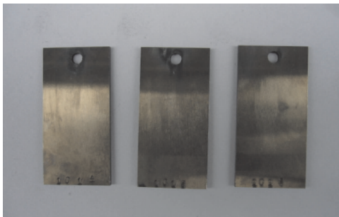
a) 腐蚀试片处理前的形貌
