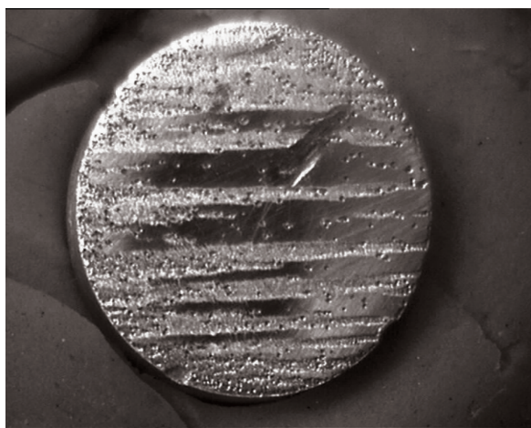
图 3 经阳极极化后的 316 L 不锈钢电极表面在金相图 ( \times 7 )
