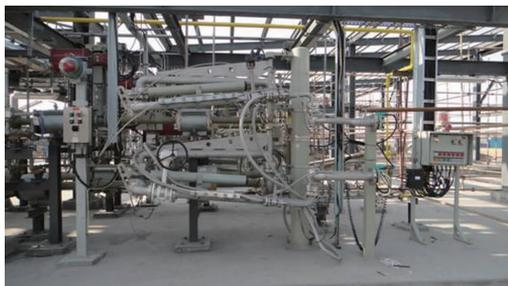
图 4 LNG 装车臂
