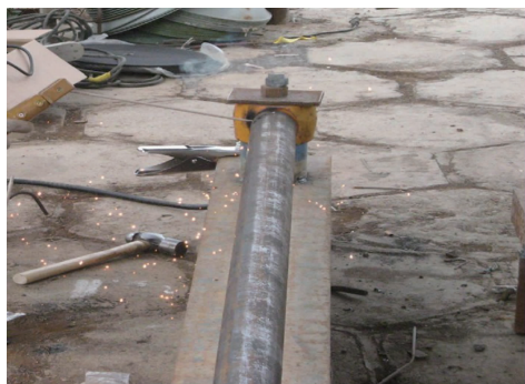
图7 连杆接头与中间管焊接图
