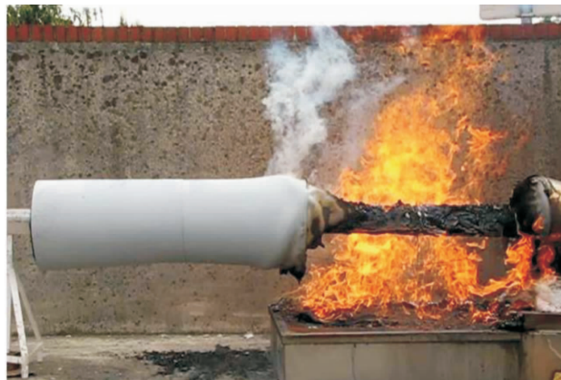
图1 有机绝热材料燃烧试验
