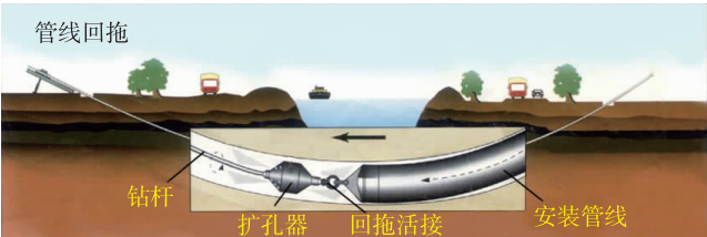
图3 管线回拖示意图
