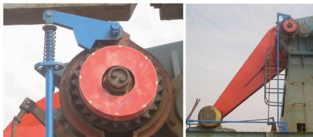
图 3 圆柱齿轮啮合式刹车防溜车装置应用
