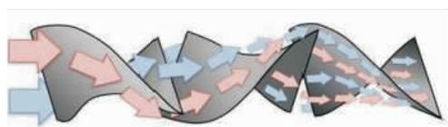
图2 凯尼斯型静态混合器
