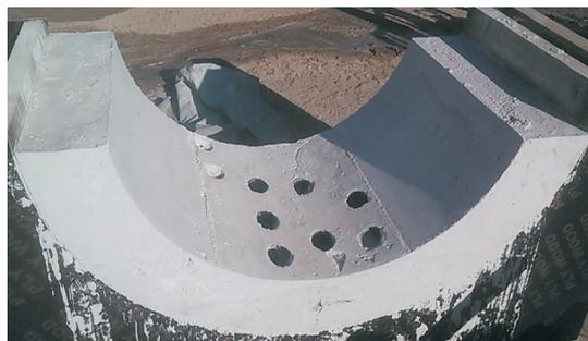
图6 制作的耐火衬里模型
