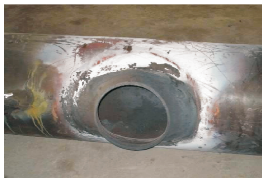
b) 筒体上热挤压拔制出的支管
