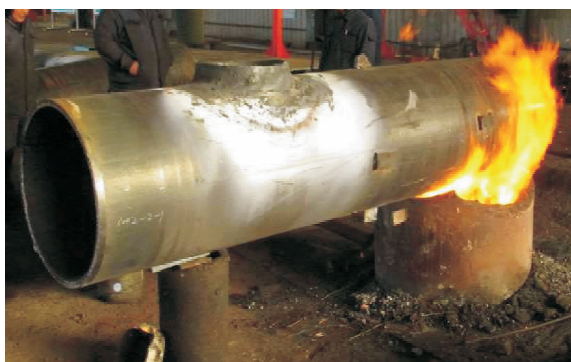
a) 支管口位置局部火焰加热
