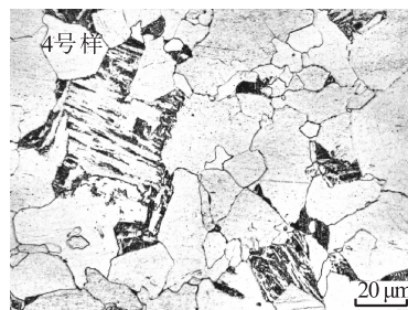
图 2 汇管用钢经不同温度加热,650 °C 回火后金相组织
