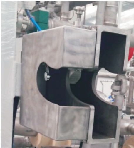
图1 鹤管归位锁紧装置组成结构及工程现场应用
