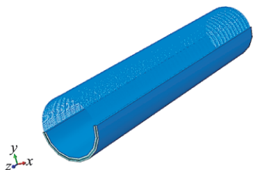
图5 RTP管有限元模型
