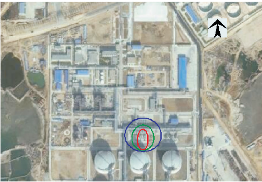
图 10 GIS 上喷射火不同热辐射强度对应影响范围
