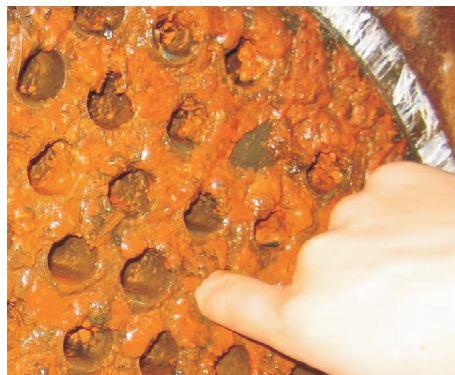
图 2 冷凝器盘管附着棕红色软质沉积物
