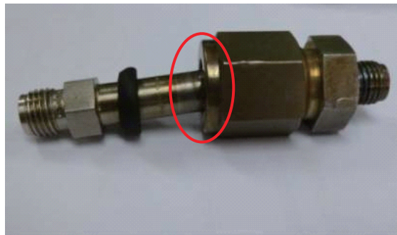
图2 现场绝缘卡套接头被击穿情况
