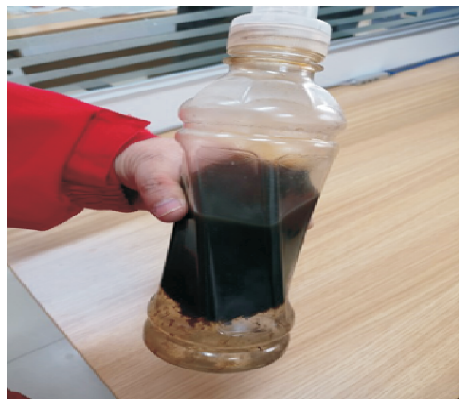
图 4 油样加水后分三层照片
