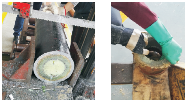
图 4 ACP 管外环空封隔后的截面图
