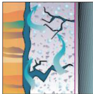
图2 体积收缩导致本体破碎图
