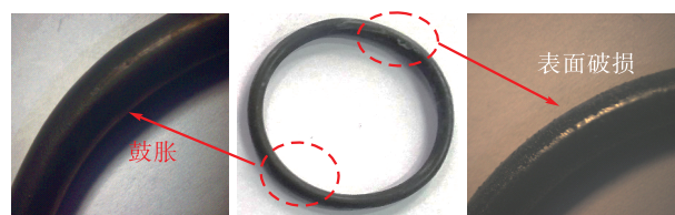
图 7 橡胶圈自由状态下腐蚀试验后形貌图
