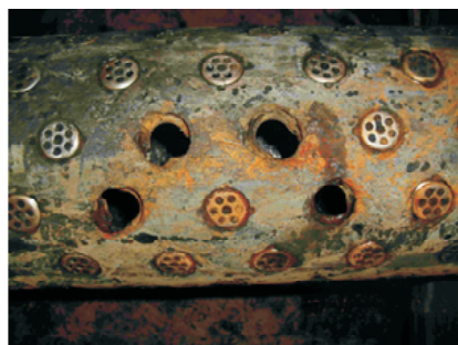
c) 筛扣与管体连接处锈蚀
