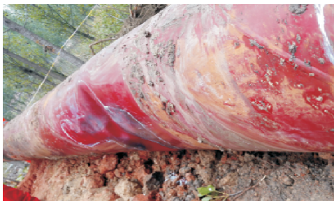
图 4 停球卡堵点现场照片
