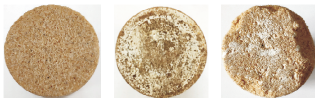
图 8 固相侵入损害前、损害后、冲击作用后的岩心端面形貌变化照片
