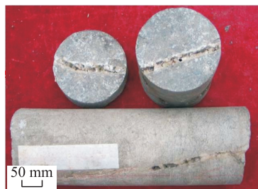
a) 大一亚段, 介屑灰岩中构造缝充填的方解石溶蚀后形成溶蚀缝洞
