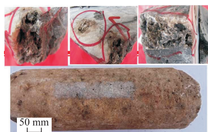
c) 大安寨段, 介壳灰岩, 发育溶蚀孔洞, 见油迹、有油味
