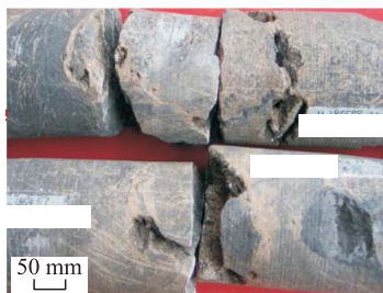
b) 大一亚段, 3 854. 36 ~ 3855. 16 m, 介壳灰岩夹灰色泥岩, 发育溶蚀孔洞
