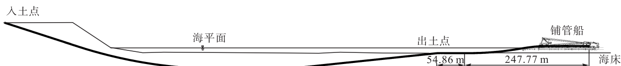
图 4 S-lay 铺设长度图
