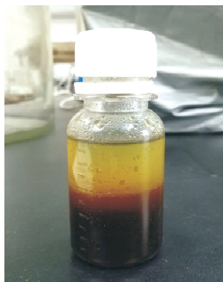
图 2 正己烷萃取三甘醇富液照片
