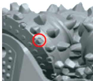
图 3 镶齿牙轮钻头特制保径齿设计示意图
