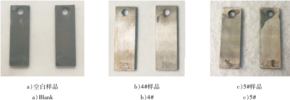
图 2 空白、4#和 5#样品清洗后的挂片腐蚀形态照片
