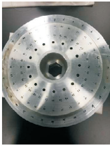
图 7 膨胀轮模态测试激励点照片
